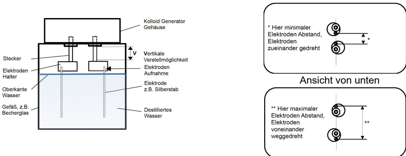
Bitte achten Sie darauf, dass die Elektrodenhalter selbst niemals das Wasser berühren, sondern ca. 5 mm über der Wasseroberfläche positioniert sind!
